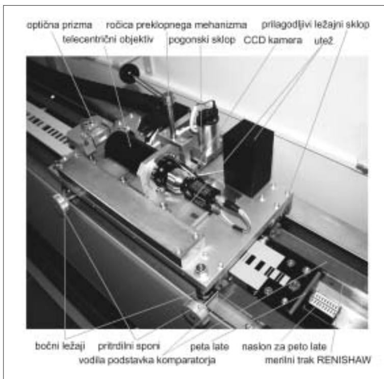
Slika 2: Merilni voziček na podstavku komparatorja in vpeta nivelmanska lata
