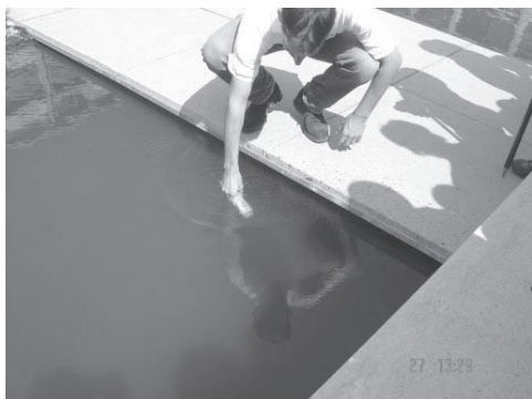
Slika 2: Preizkus vodoodpornosti dlančnika v tovarni Leica.
