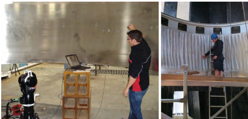
Slika 8: Merjenje gonilnikovega obroča z laserskim sledilnikom v tovarni in na terenu.
