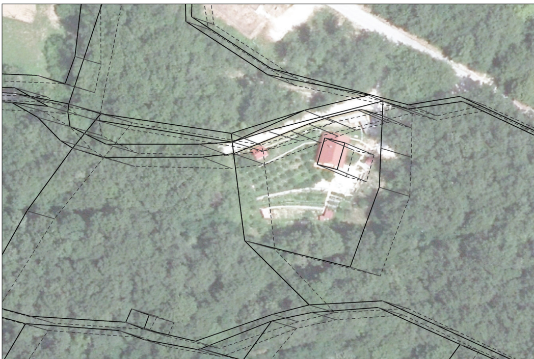
Slika 3: Primer večjih sistematičnih pogreškov v k. o. Črešnjice, prikazan na podlagi DOF (lastni prikaz).
