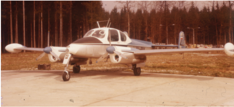
Slika 1: Morava L-200 YU-BBK (pod trupom vidna glava navigacijskega daljnogleda Zeiss-Opton NT-1).
