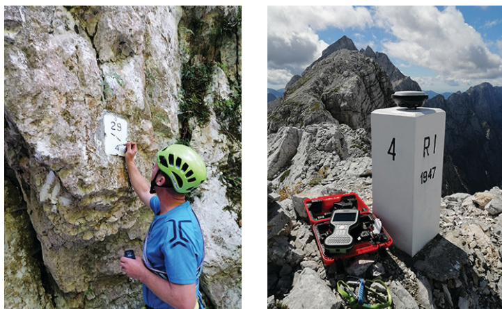
Slika 3: Primer oznake poteka državne meje v skali (levo) in določevanje položaja mejnega znamenja z izmero GNSS (desno) (foto: K. Medved).
