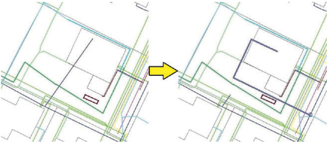
Slika 3: Dopolnjen prikaz vodov zbirnega katastra GJI za lastne potrebe – stanje pred izkopom vodovoda (levo) in po izkopu (desno). Vidna je sprememba poteka vodovoda, prikazana v temno modri barvi.
