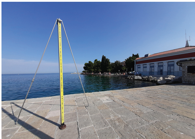
Slika 3: Izmera mestne nivelmanske mreže Izola (foto: Goran Tisak).
