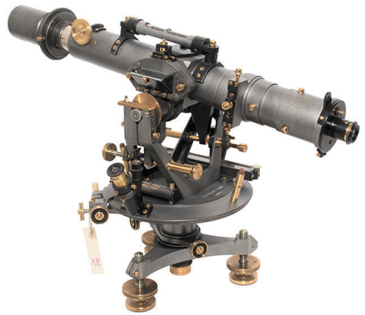
Slika 10: Tahimeter Otto Fennel & Söhne Kassel, ser. št. 16401, evid. št. 18 (foto: Mateja Urbas).
