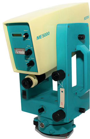
Slika 13: Precizni razdaljemer Kern, Mekometer ME 5000, ser. št. 357043, evid. št. 87 (foto: Mateja Urbas).
