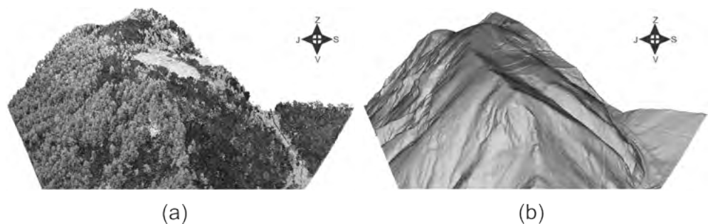
Slika 7: Oblak točk lidar testnega primera hriba iz okolice Zagorja ob Savi (a) ter izhodni DMR (b)
