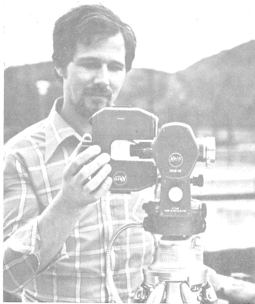
Slika 2. Z enostavno staknitvijo DM 501 z dajnogledom na teodolitu nastane priročen elektrooptični daljinomer.
