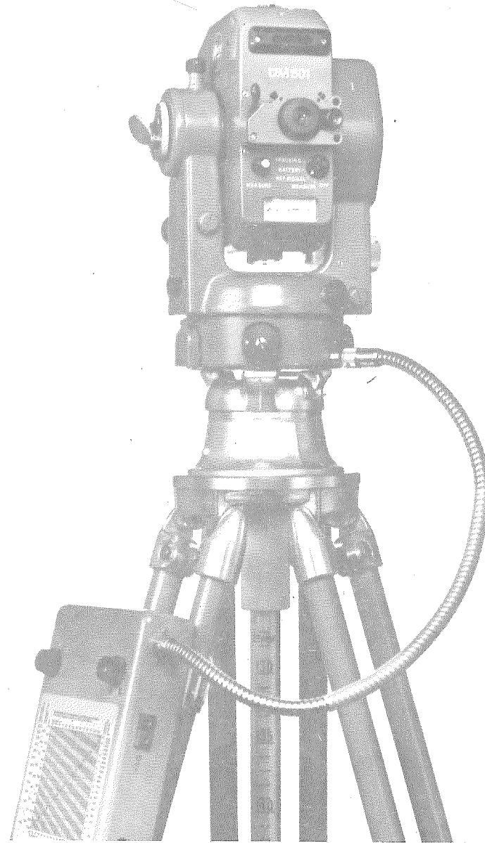
Slika 1. Elektrooptični daljinomer DM 501, nasajen na dajnogled sekundnega teodolita DKM2-A. Na stojalu je pritrjen s polnilnikom. Napajalni kabel, ki je priključen na stabilni podstavek teodolita, ne ovira prostega gibanja instrumenta.
