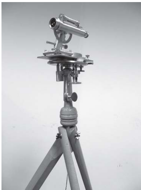
Slika 2: Teodolit Neuhofer&Sohn, Dunaj, z doma narejenim stojalom
