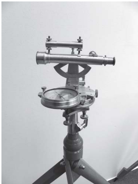
Slika 3: Teodolit Gebruder Frome
