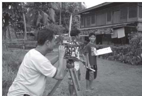
Slika 2: Za merjenje razdalj je na instrument pritrjen laserski merilec.
