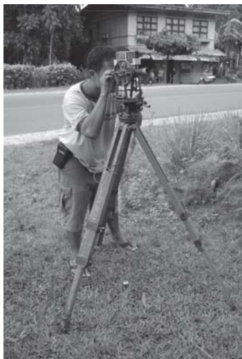
Slika 3: Instrument je centriran z mehanskim grezilom.
