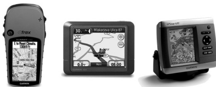
Slika 1: GPS-navigacijski instrumenti: levo – osebni, sredina – avtomobilski, desno – navtični (vir: http://www.garmin.si )
