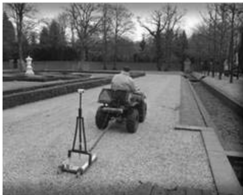
Slika 1: Detektor za iskanje cevi (podjetje Groundtracer Systems, Nizozemska)
