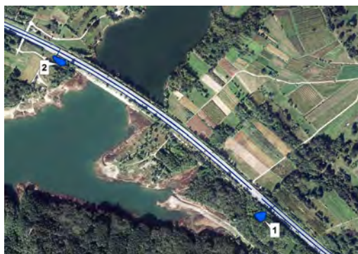
Slika 3: Shema cestne kanalizacije (modre črte) in zadrževalnika meteornih vod z lovilci olj (1 in 2) na območju zadrževalnika Vogršček (vir: DOF 2010, GURS; ZK GJI, GURS; izdelava slike: Matjaž Tratnik).
