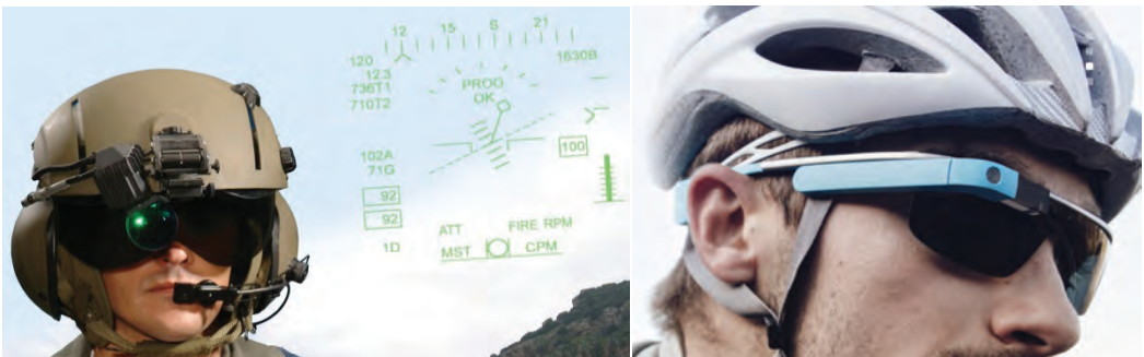
Slika 8: Projekcija podatkov na mini zaslon pred očesom – levo: vojaško, pritrjeno na bojno čelado (vir: https://www.elbitsystems.com/ ), desno: civilno, pritrjeno na očala (vir: http://www.google.com/glass/ ).
