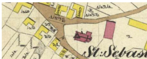
Slika 3: Detajl iz katastrskega načrta, izdelanega v sklopu katastrskih izmer v sistemu Gellért. Na načrtu so vidne sledi svinčnika, kar priča o vestnem prenosu izmerjenih koordinat v grafiko.
