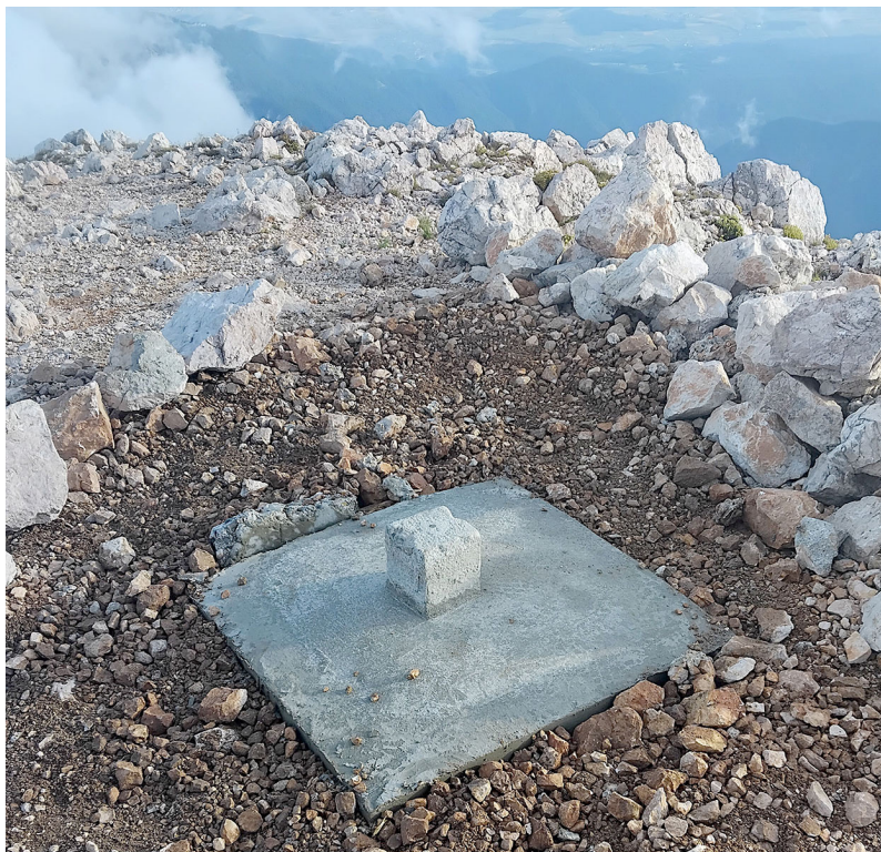
Slika 6: Stanje trigonometra (167z1) po obnovi.
