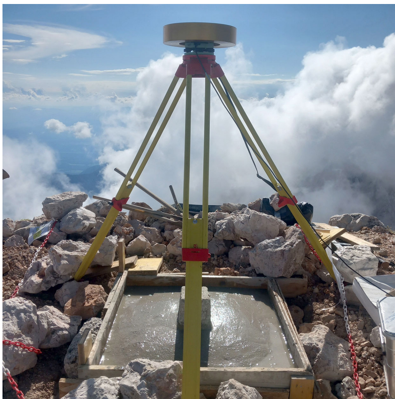
Slika 7: GNSS-izmera po koncu obnove na trigonometru (167z1) in s trinožnim stativom.
