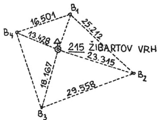
Slika 5: Položaji bočnih zavarovanj B1, B2, B3 in B4 glede na točko 215 Žigartov vrh s pripadajočimi frontami (levo), bočno zavarovanje B3 s pogledom proti jasi na Žigartovem vrhu (desno), 13. 7. 2023 (vir: GURS, foto: R. Škafar, GURS).
