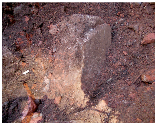
Slika 6: Fotografiji izkopa na lokaciji glavne točke Z9 z vidnim temeljem z letnico 1897, ki je približno 0,5 metra zamaknjen od točke Z9 (foto: R. Škafar, GURS, 26. 10. 2023).
