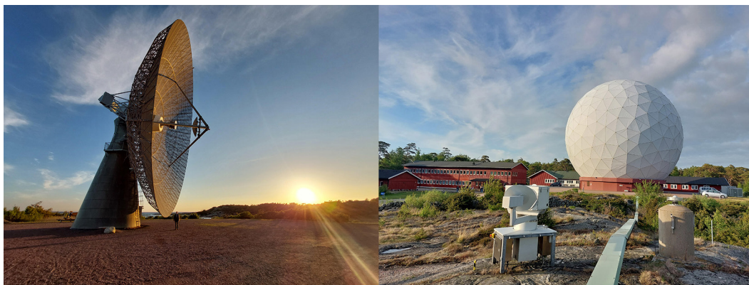
Slika 2: VLBI-radioteleskop in GNSS-postaja na opazovalnici Onsala na Švedskem – tipična infrastruktura GGSC, ki podpira ITRF. Foto: K. Medved, 2023.
